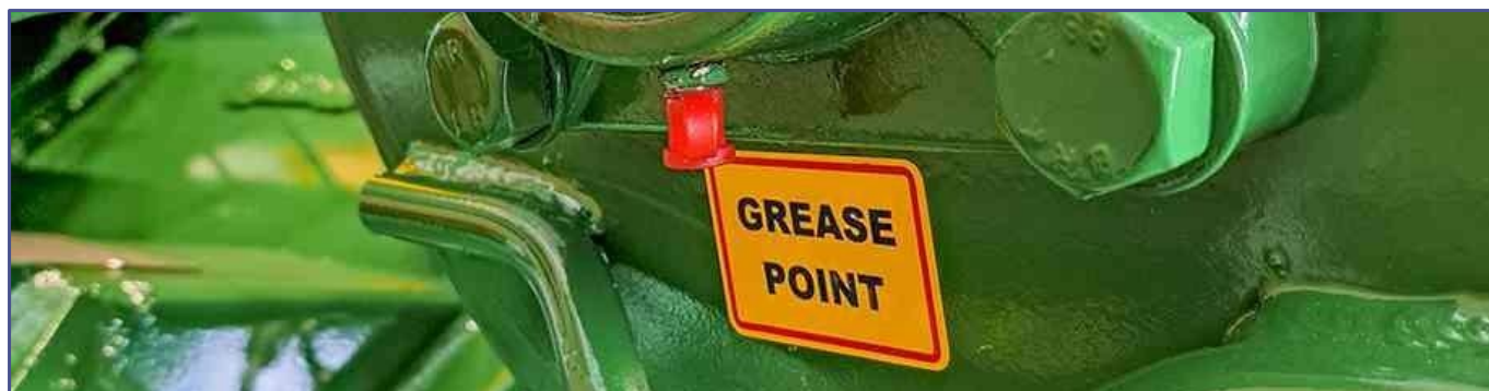
Pátý mazací bod se nachází v horní části svislého výtlačného šneku.
