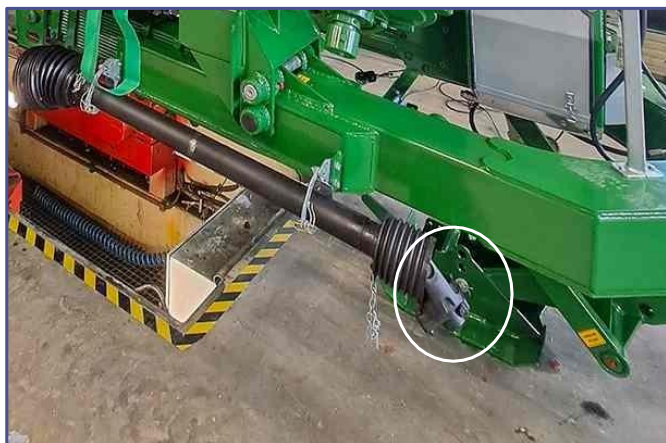
Bezpečnostní střižný šroub na vývodovém hřídeli. Uložení bezpečnostního střižného šroubu.
