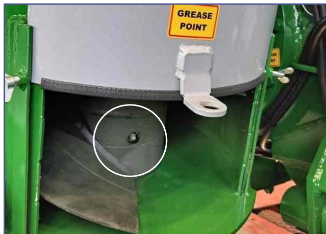
Když se hřídel otáčí, mazací body jsou vidět jsou viditelné
