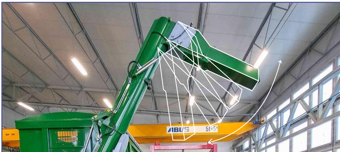
Plnicí potrubí v "pracovní poloze", úhel lze měnit hydraulickým válcem.
