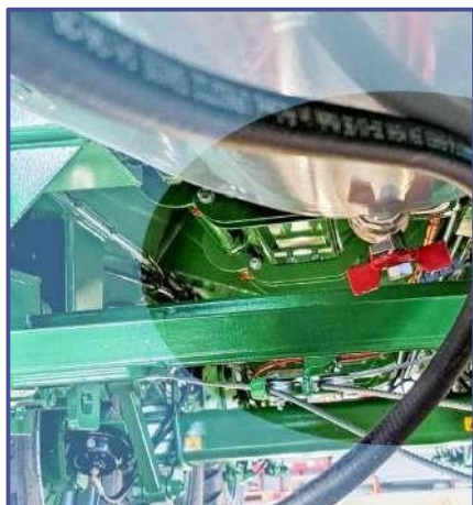
Vypouštěcí kohout je zavřený
