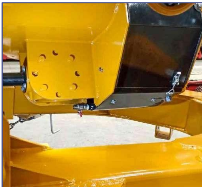
Nádrž na olej Sběrná nádoba na použitý olej a vypouštěcí kohoutek
