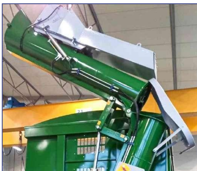
Vertikální vykládací šnek je konstruován pro mazání ložisek.
