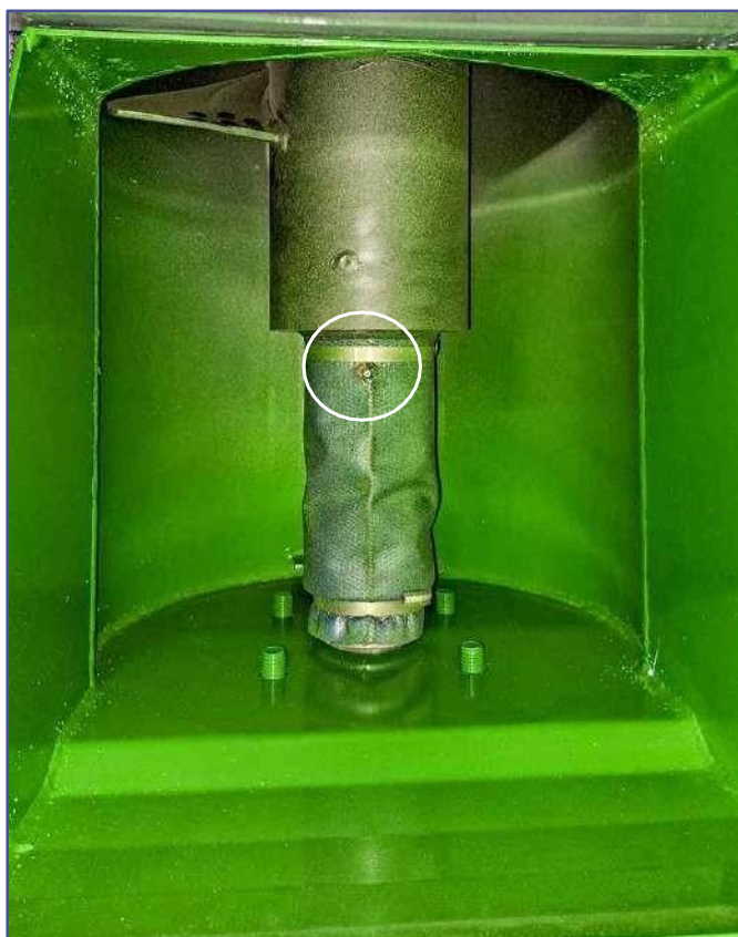
Pátý mazací bod se nachází v horní části svislého výtlačného šneku.
