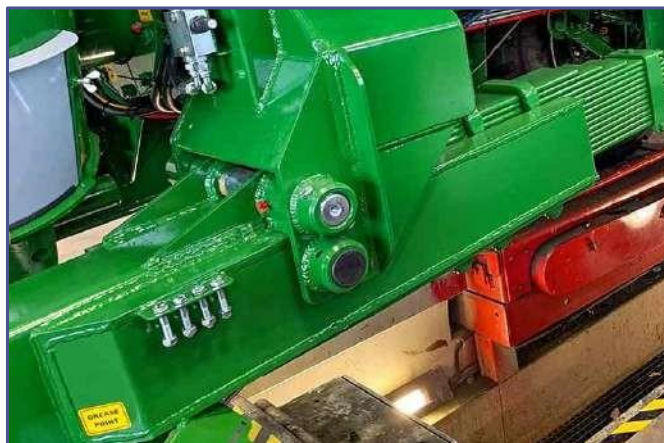
Bezpečnostní střižný šroub na vývodovém hřídeli. Uložení bezpečnostního střižného šroubu.
