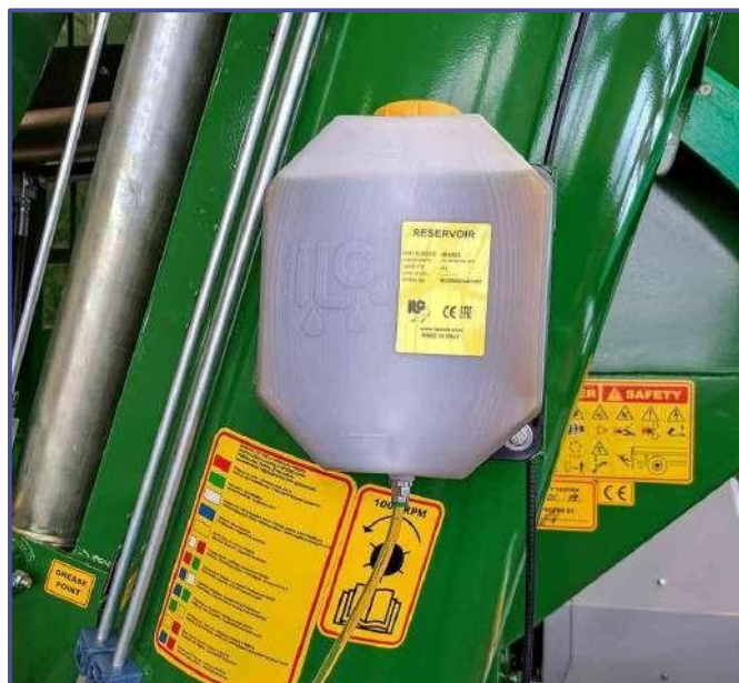
Nádrž na olej Sběrná nádoba na použitý olej a vypouštěcí kohoutek
