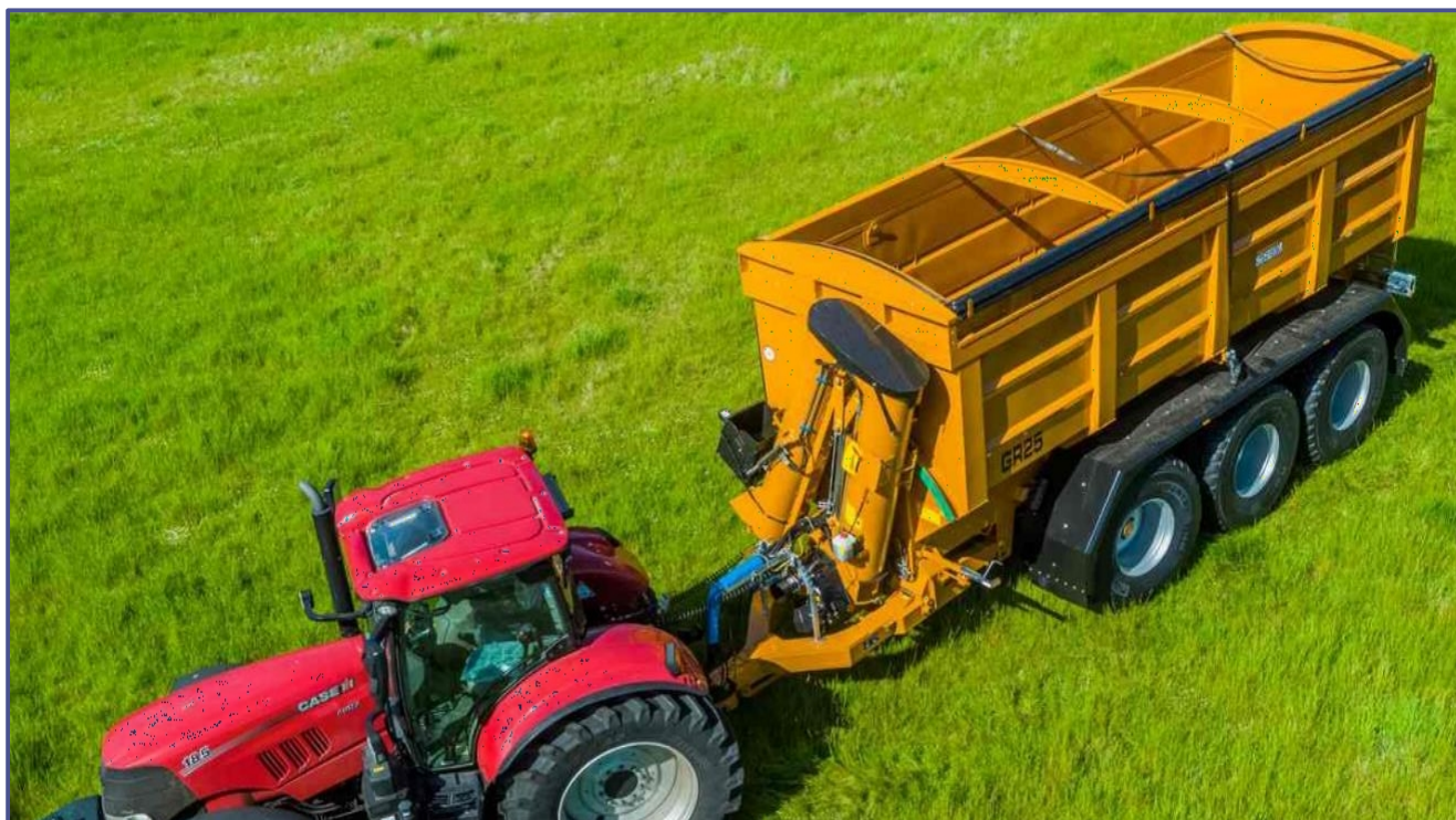
Plnicí potrubí v "pracovní poloze", úhel lze měnit hydraulickým válcem.
